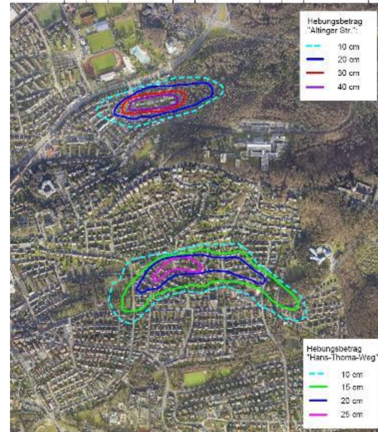
Ergebnisse der Laserscanbefliegung im Auftrag des LGRB Höhenvergleich 2014 / 2002
